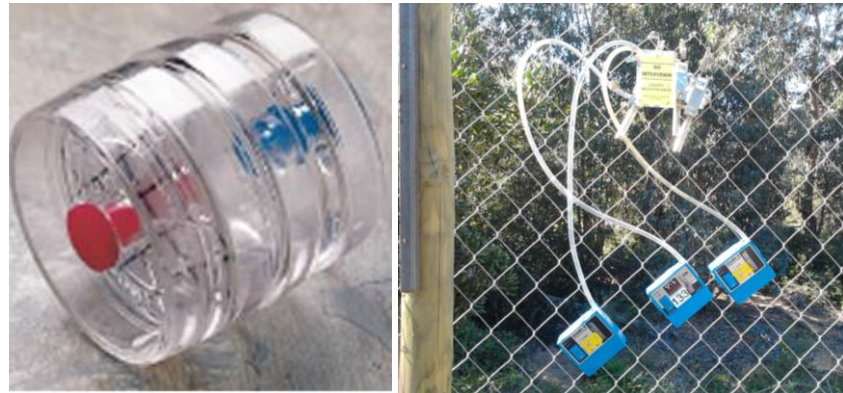
Figura 1. Filtro de PVC o celulosa con porta filtros de 1 ó 2 cuerpos, para recolección de nanopartículas ambientales.
