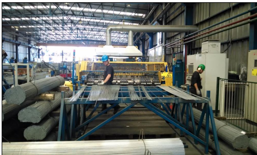
Imagen 3 Sección de Electrosoldadura.
