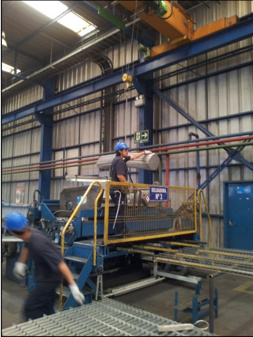
Imagen 17 Carga de alambre cortado a Soldadora 3 desde Punte Grúa.
