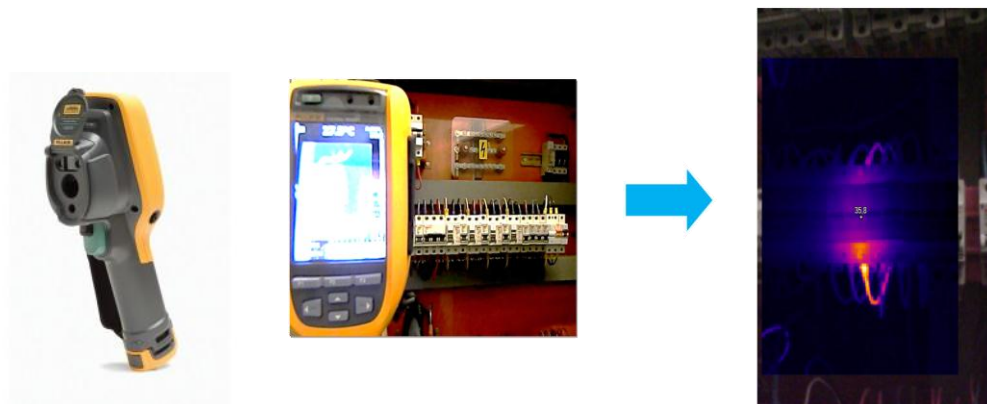
Figura 29. Cámara Termográfica e inspección infrarroja
