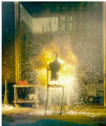
Figura 8: Maniquí de ensayo con una chaqueta que ha sido expuesto a un ensayo en caja (Box-Test). De acuerdo a norma CEI o EN 61482 6 -1-1 y el ensayo en caja (Box-Test) según la norma IEC o EN 61482-1-2.
