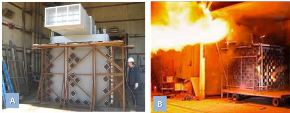
Figura 87: Pruebas en equipos arco-resistentes. Foto A, se aprecian los “testigos” que recogen muestras de ignición en ensayos. Foto B corresponde a la prueba del equipo Unigear ABB, ancho panel 800 mm, corriente de falla 50 kA, 1 s de duración, ignición del cubículo de barras [43].
