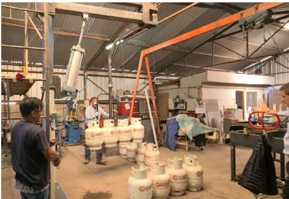
El 13 de Marzo de 2024, se realizó satisfactoriamente las pruebas de agarre estable de 4 cilindros simultáneos, y el apilado en 3 niveles.
