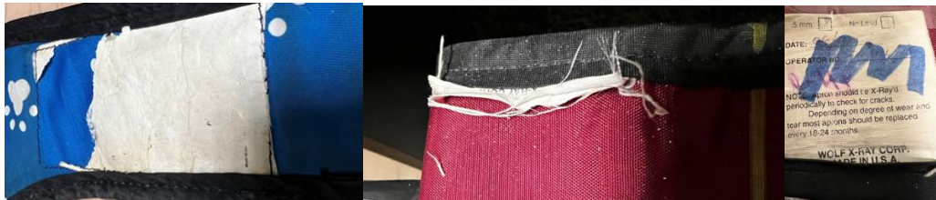
Figura 2: Deterioro en etiquetas de elementos de protección radiológica, derecha etiqueta rayada, centro cortada e izquierda completamente desgastada.
