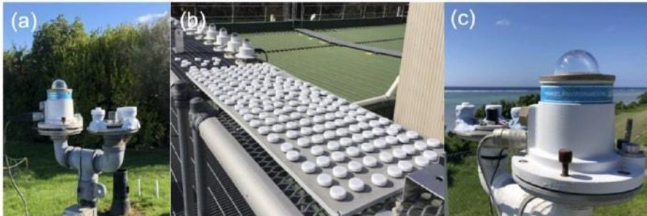
Figura 10. Ilustración del montaje que se debe utilizar para la calibración. Se muestran los dosímetros y el detector calibrado.
