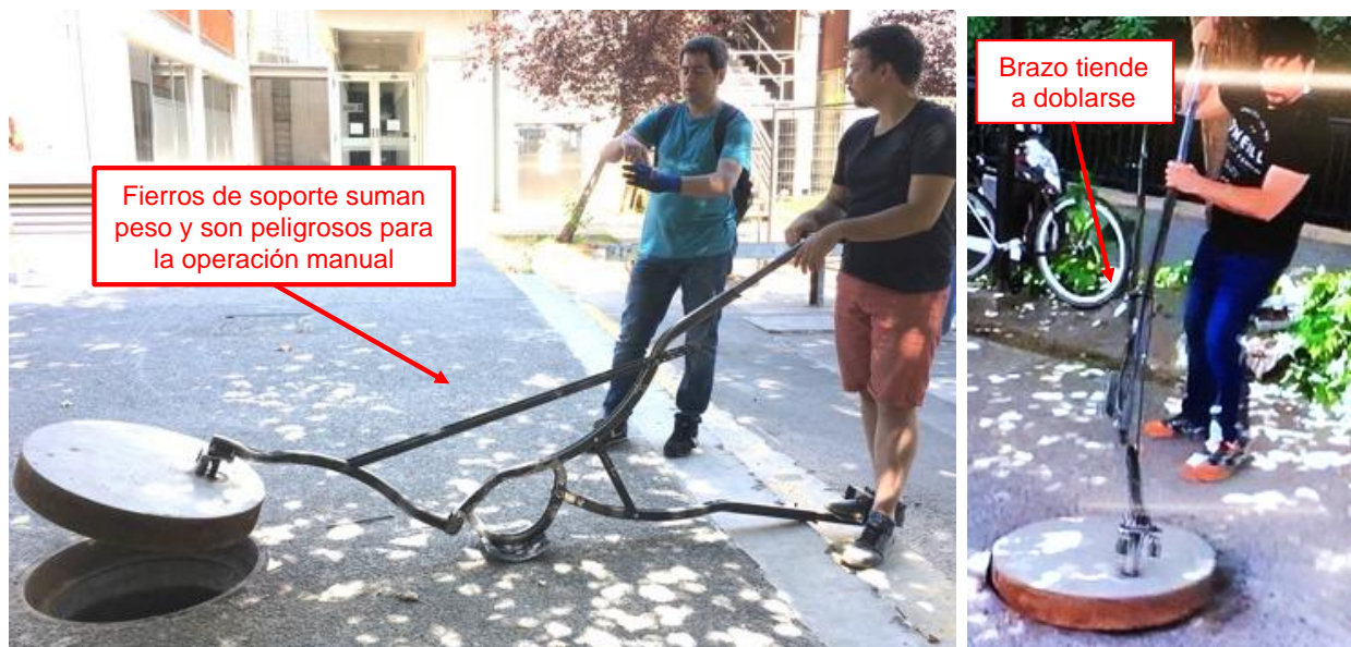
Imagen 15: Pruebas internas previa al testeo con operadores de terreno.
