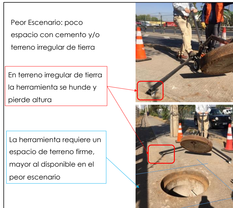
Imagen 22: Análisis de pruebas de prototipos en terreno
