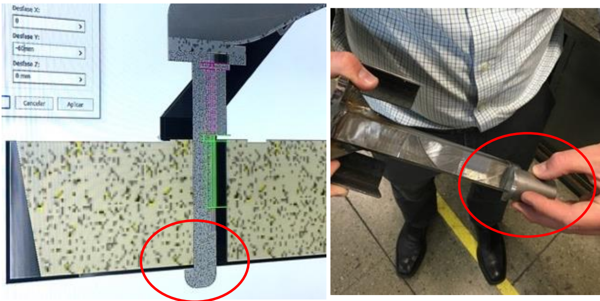
Imagen 10: Bosquejo digital y prototipo construido del sistema de enganche
