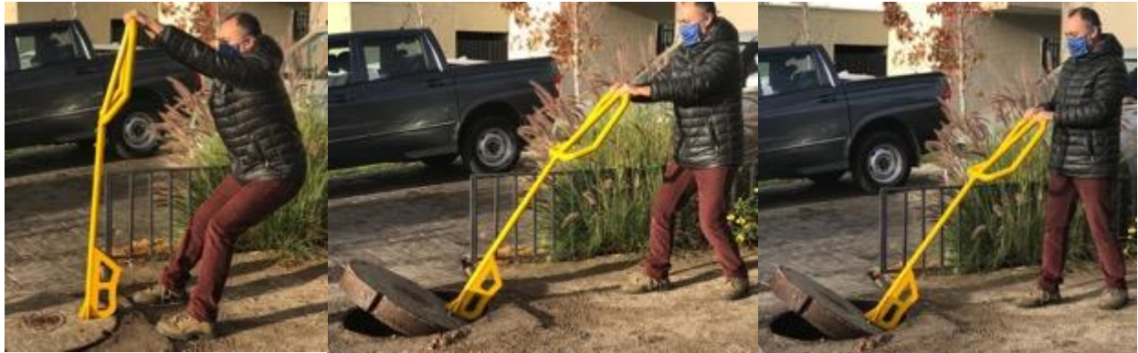
Imagen 37: Secuencia de destapado de tapas con prototipo final
