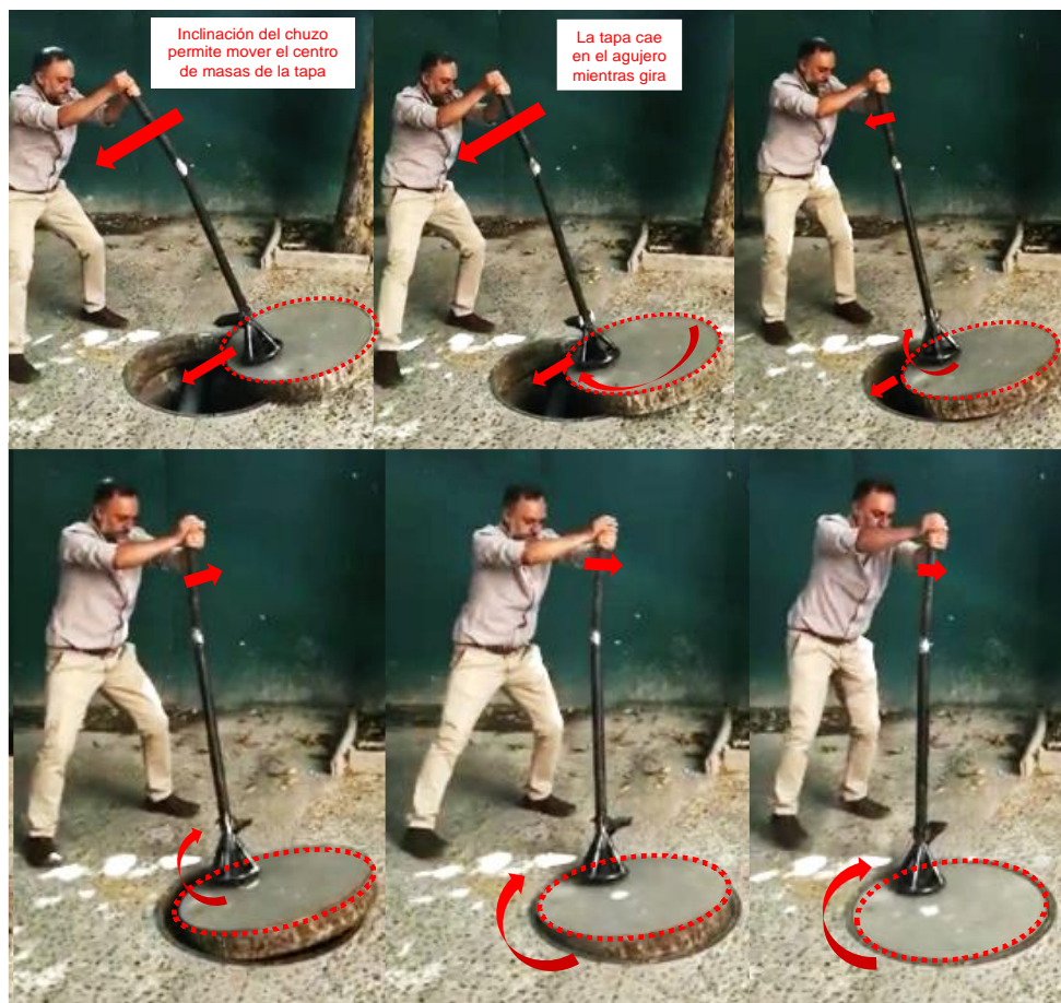
Pruebas de manipulación de tapas, sobre tapas desagripadas.
