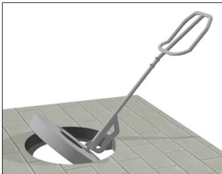
Imagen 34: Vista de herramienta Chuzo 2.0, Desencajando la tapa de hormigón
