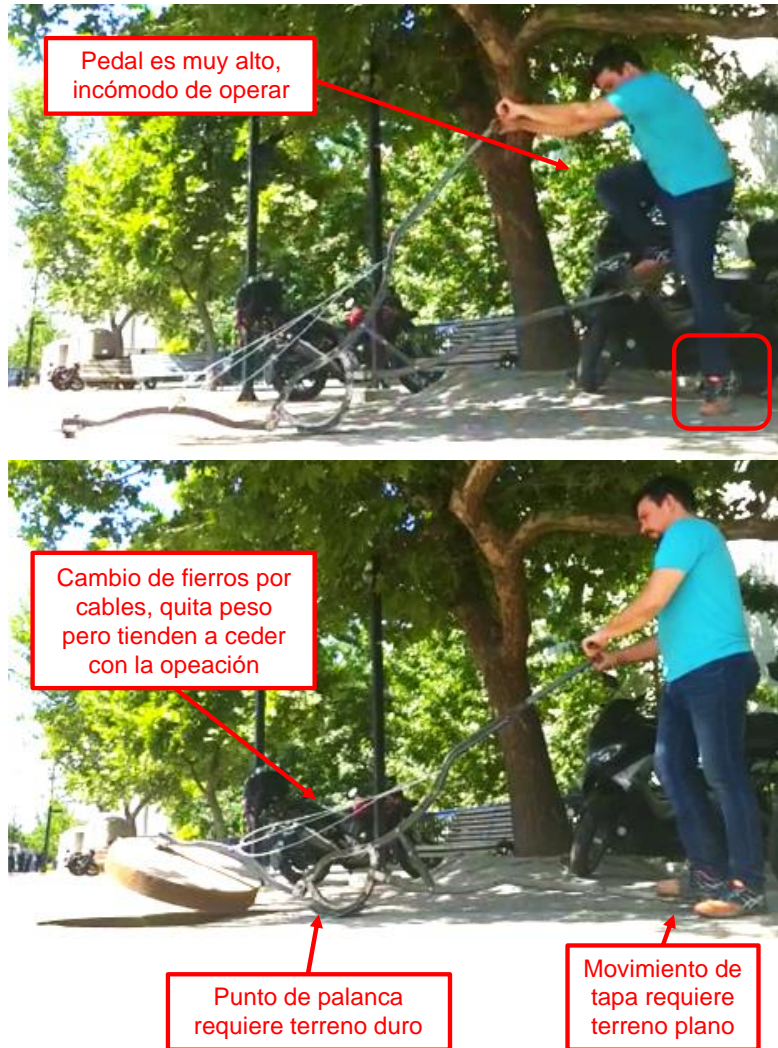
Imagen 16: Pruebas internas y ajustes previos al testeó con operadores de terreno.
