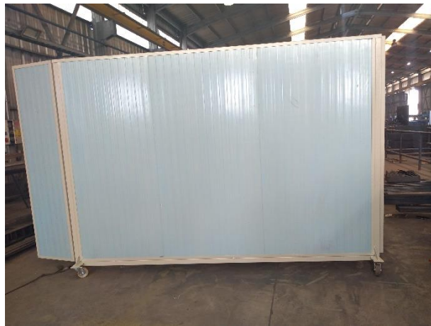
Figura 35. Fotografías de las barreras acústicas fabricadas.
