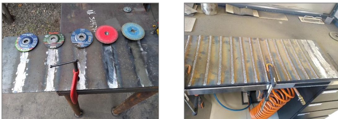
Figura 29. Discos utilizados en las pruebas (izquierda) y placa de acero utilizada
