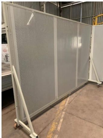
Figura 35. Fotografías de las barreras acústicas fabricadas.
