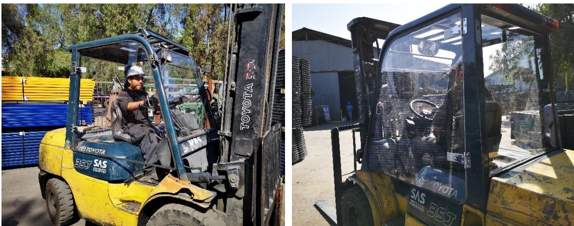
Figura 41. Cabina implementada en grúa horquilla.
