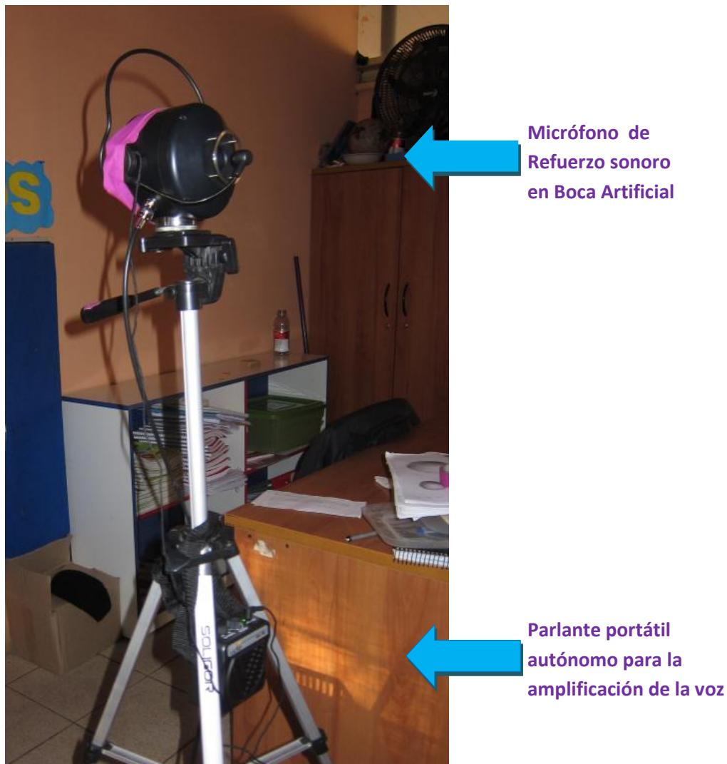
Figura 5.- Montaje de terreno de la boca artificial y de sistema de refuerzo sonoro autónomo para la amplificación de la voz.
