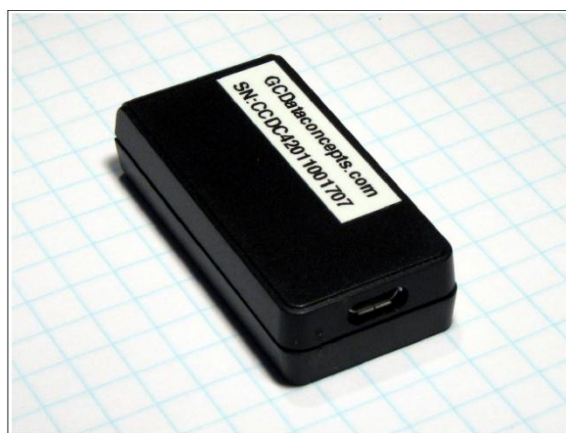
Figura 4.- Acelerómetro triaxial digital utilizado
