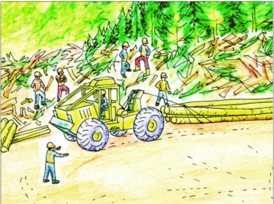
**Figura N°9:** Ubicación del personal al ingreso del skidder a la cancha.
