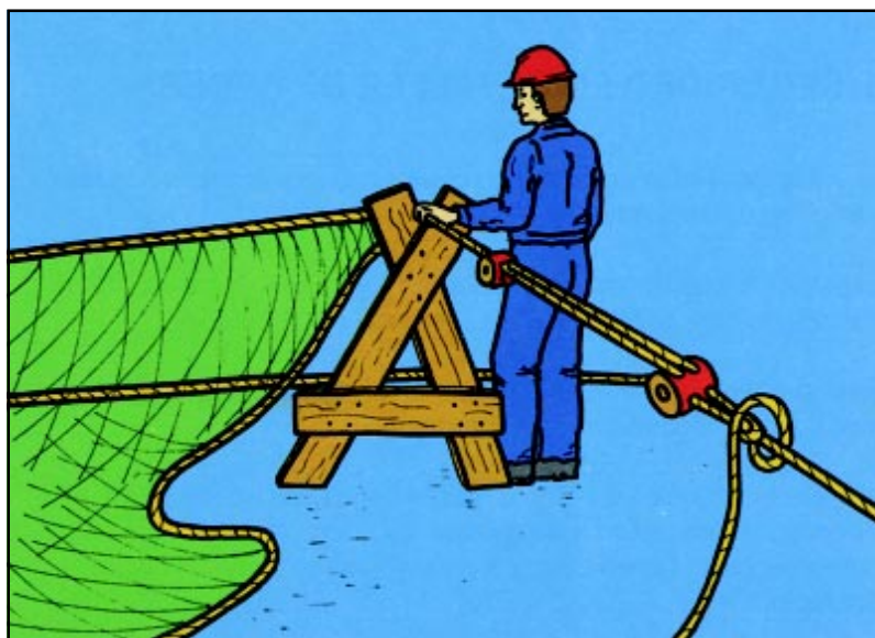
Figura 8. Los aparejos que se emplean para tensar los cabos de las redes se deben examinar para descubrir fallas del material.
