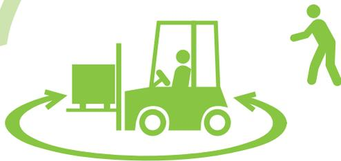
Mantenerse alejado del radio de giro de las máquinas (dos pasos de la extensión máxima del equipo).
