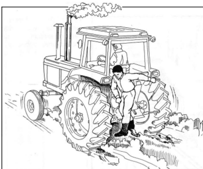
10. En operación no debe mantenerse el pedal de embrague o frenos presionado.
