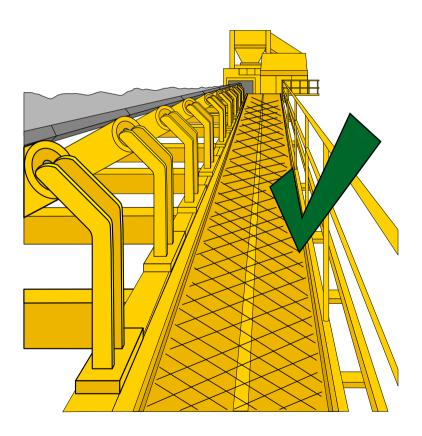
Los equipos de apilamientos de materiales deberán tener dispositivos que permitan efectuar un control del polvo que resulta de la operación. Igual medida se aplicará en chutes, harneros, etc.
