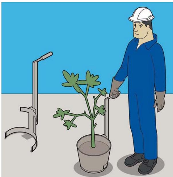
**Figura 4.39** Accesorio para transportar objetos cilíndricos (maceteros, latas de pintura, etc.).
