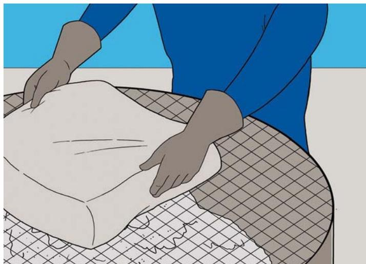
**Figura 4.49** Usar una rejilla elimina el esfuerzo asociado a sostener este saco durante su descarga.
