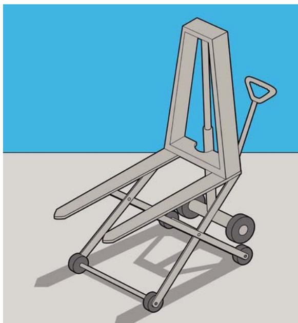
**Figura 4.72** Transpaleta de tijera simple, de altura regulable.
